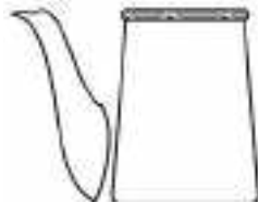
5 Saldobrasatura collo di cigno Goose-neck braze-welding
